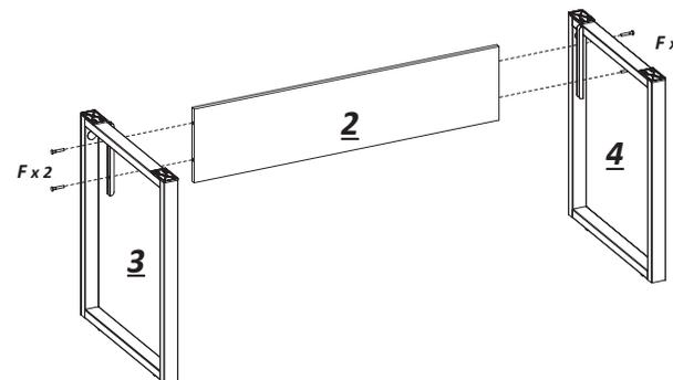
**2.1** Monte os pés ao painel frontal. Para fixar os parafusos utilize a chave allen de 4mm. Em seguida, instale as tampinhas H na cabeça dos parafusos.
