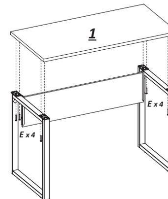
**2.2** Por fim, posicione o tampo e fixe com os parafusos indicados.
